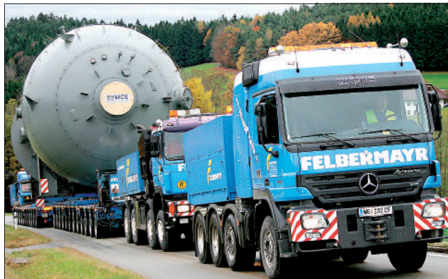
Im Bild: Spezialtransport eines Reaktors von Linz nach Burghausen.
