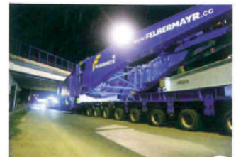
Die »Heben- und Senken-Funktion« ermöglichte auch ein Unterfahren von Brücken.
