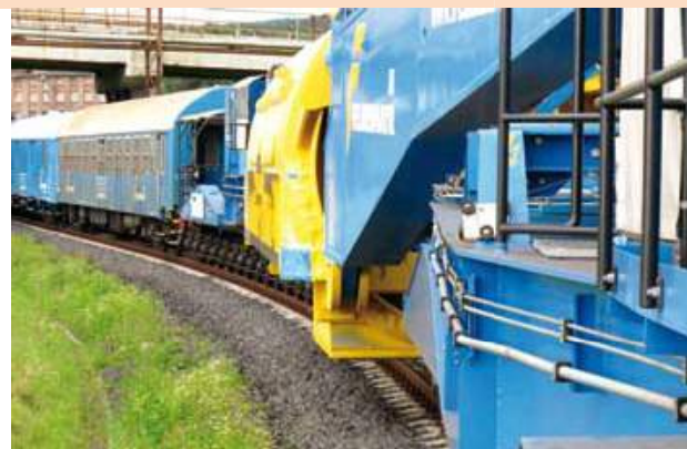
Mit 4 m Breite und mehr als 4 m Höhe war das Lichtraumprofil der Bahn deutlich überschritten, so dass es an manchen Engstellen nur im Schrittempo vorwärts ging
