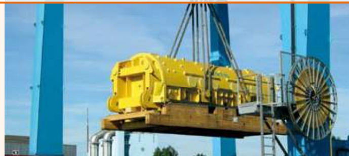
Umschlag des Generators von Bord des Binnenschiffes auf den Bahnwagen im Felbermayr Schwerguthafen Linz
