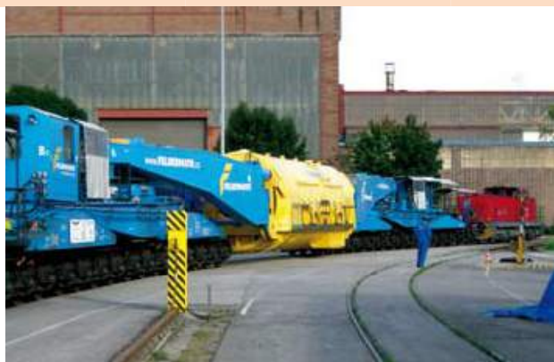
Weitertransport von Linz nach Ledvice mit einem 32-achsigen Tragschnabelwagen, der Stückgewichte bis 500 t bewegen kann
