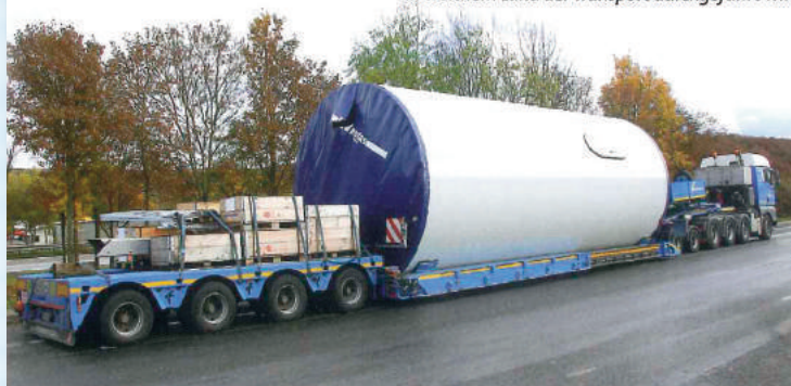
Turmadapter, teleskopierbarer Semi, Kesselbrücke: Durchmesser und Länge bestimmen im Wesentlichen was, für welches Turmteil zum Einsatz kommt – und, wie sollte es anders sein, in welchem Land der Transport durchgeführt wird.
