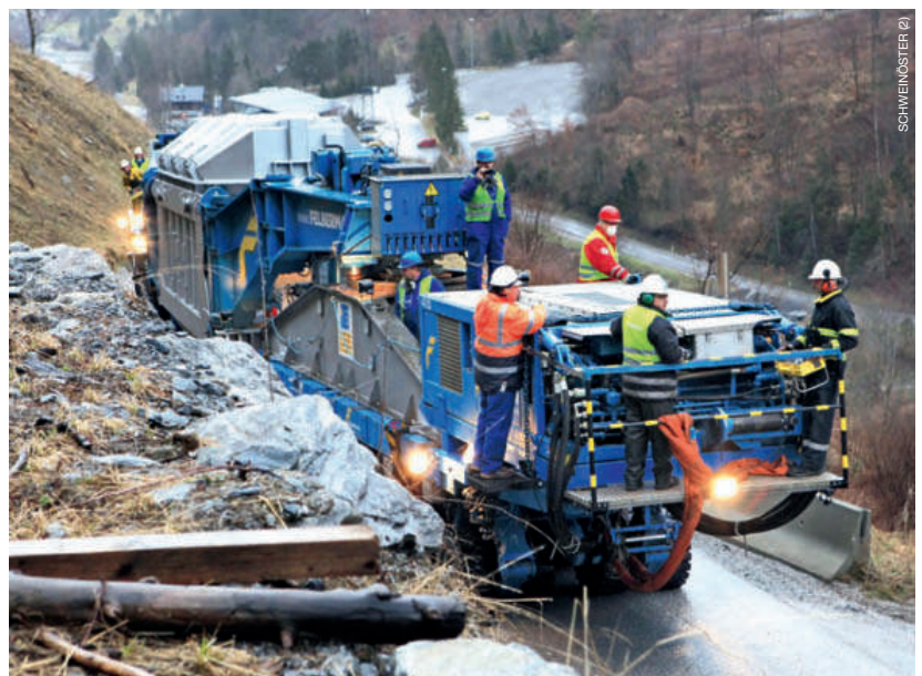
26 Kilometer wurde der Trafo auf dem SPMT (Selbstfahrer) transportiert
