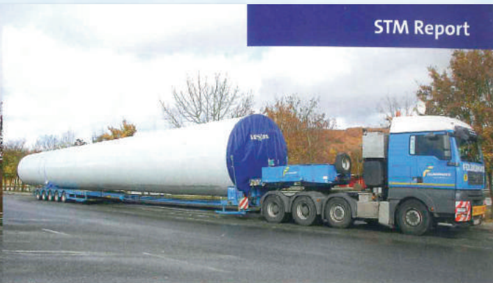
Turmadapter, teleskopierbarer Semi, Kesselbrücke: Durchmesser und Länge bestimmen im Wesentlichen was, für welches Turmteil zum Einsatz kommt – und, wie sollte es anders sein, in welchem Land der Transport durchgeführt wird.
