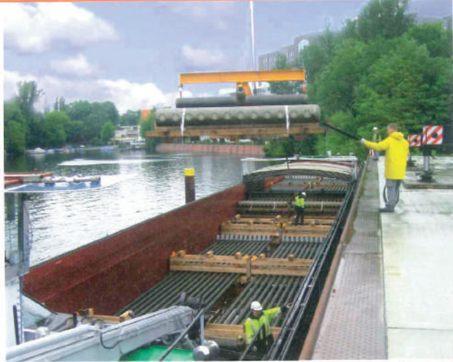
Projektverladung an der Schwerlastplatte im revitalisierten Berliner Borsighafen: 40 Kühlaggregate zu je 23 t sind für eine Ethylenanlage im Nordosten Chinas bestimmt
