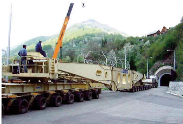
Bei der „Schablonenfahrt“ zur Simulation des Transports der Transformatoren stellte sich heraus, dass eine Ladung dieser Größe nicht durch den Tunnel passt.
