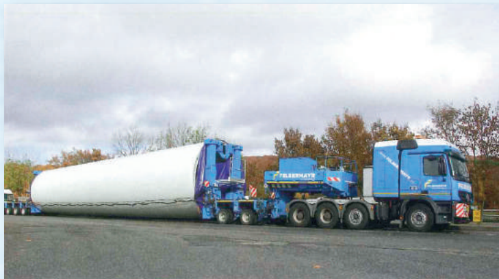
Turmadapter, teleskopierbarer Semi, Kesselbrücke: Durchmesser und Länge bestimmen im Wesentlichen was, für welches Turmteil zum Einsatz kommt – und, wie sollte es anders sein, in welchem Land der Transport durchgeführt wird.
