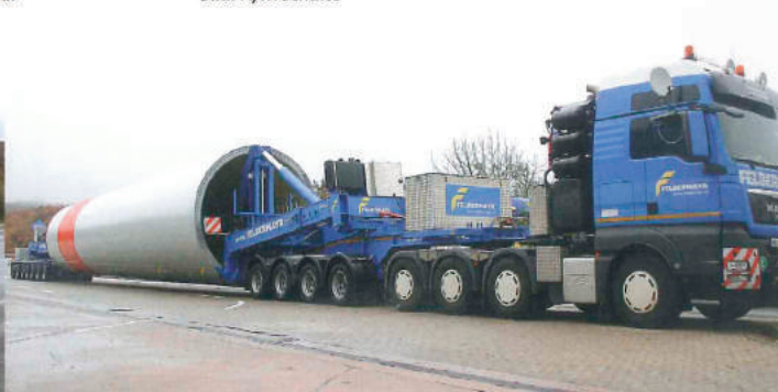
Turmadapter, teleskopierbarer Semi, Kesselbrücke: Durchmesser und Länge bestimmen im Wesentlichen was, für welches Turmteil zum Einsatz kommt – und, wie sollte es anders sein, in welchem Land der Transport durchgeführt wird.
