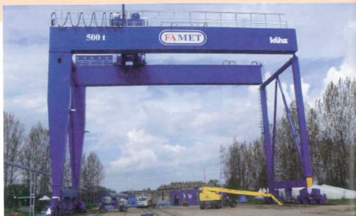
Das neue Schwergut-Zentrum in Opolo (Oppeln) an der Oder verfügt über einen 500-t-Kran der Firma Künz
