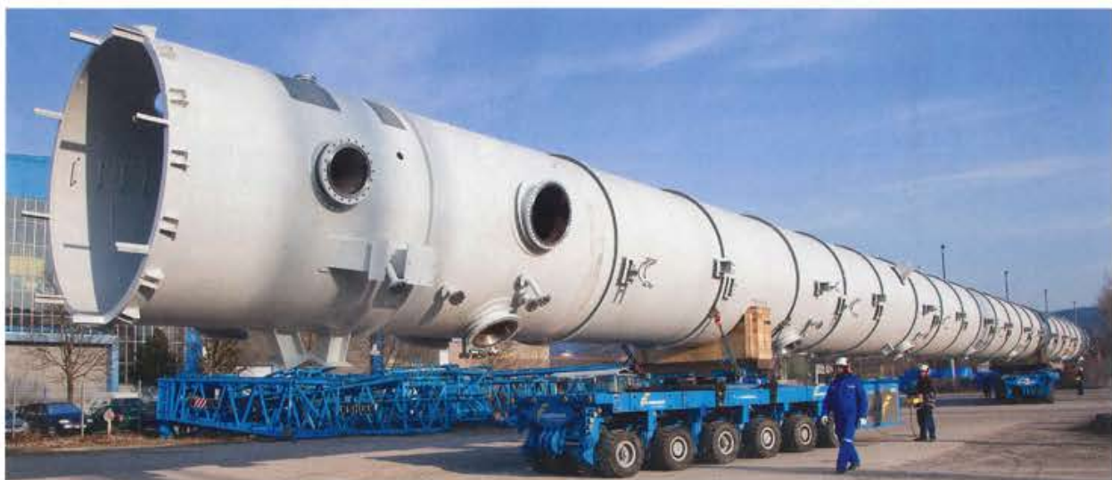
Für besonders lange und schwere Brocken kommen bei Felbermayr SPMT's (Selbstfahrer) zum Einsatz.
