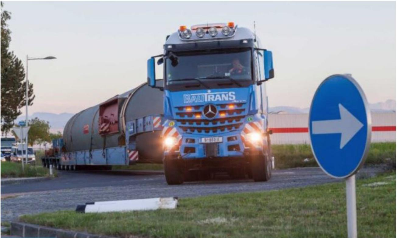
Bau-Trans absolvierte Anfang September zwei Sondertransporte mit einer Hubhebelbrücke. Ausgehend von Steinhaus bei Wels wurden dabei Behälter mit jeweils 86 Tonnen befördert. Rund ein halbes Jahr dauerten die Vorbereitungsarbeiten für die Erstellung eines Transportkonzeptes für den Einsatz des Spezialtiefladers.
