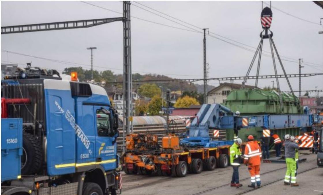
Unter Einbezug der Bau-Trans-Montagelogistik und Transportdienstleistungen sowie der ITB (Internationale Tieflader-Bahntransporte) wurde Ende Oktober ein 150 Tonnen schwerer Transformator übersiedelt. Die Route führte von Bassecourt (CH) nach Bickingen im Berner Raum. Die Besonderheit des Transportes lag in der Adaption der eingesetzten Hubhebelbrücke als Transportvorrichtung.
