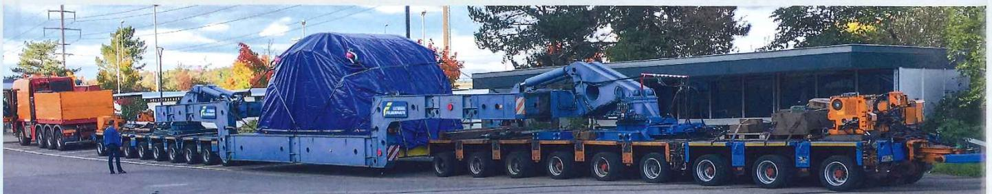
Die Statorteile wurden mit einer Hubhebelbrücke transportiert.
