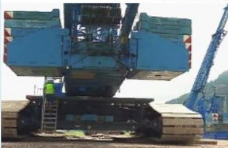
Das Eigengewicht von 600 Tonnen ermöglicht gewaltige Traglasten
