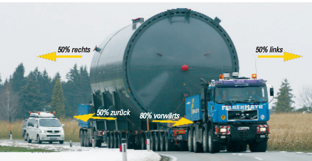
Gemäß ÖNORM EN 12195-1 ist die Ladung wie folgt zu sichern: 80 % des Ladungsgewichtes in Fahrrichtung, 50 % des Ladungsgewichtes nach hinten, und je 50 % des Ladungsgewichtes zu jeder Seite.
