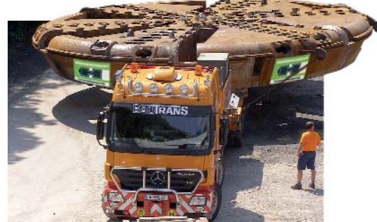
Piesa centrală a utilajului de forat în tuneluri: o roată de săpare cu diametrul de doisprezece metri și masa de 200 tone.
