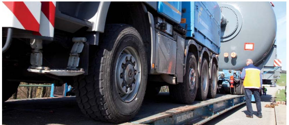
Mittels »Fly over« wurden fünf Brücken überquert. Deren Traglast hätte dem Gesamtgewicht des Transports von 220 Tonnen sonst nicht standgehalten.
