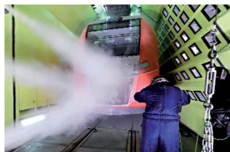
Im Klima-Wind-Kanal des Rail Tec Arsenal in Wien testete Siemens den neuen Regionaltriebzug Desiro RUS für die Russischen Eisenbahnen (RZD). Die Versuche mit künstlichem Wind, Eis, Regen und Schnee liefen bei -40 bis +45 Grad Celsius.
