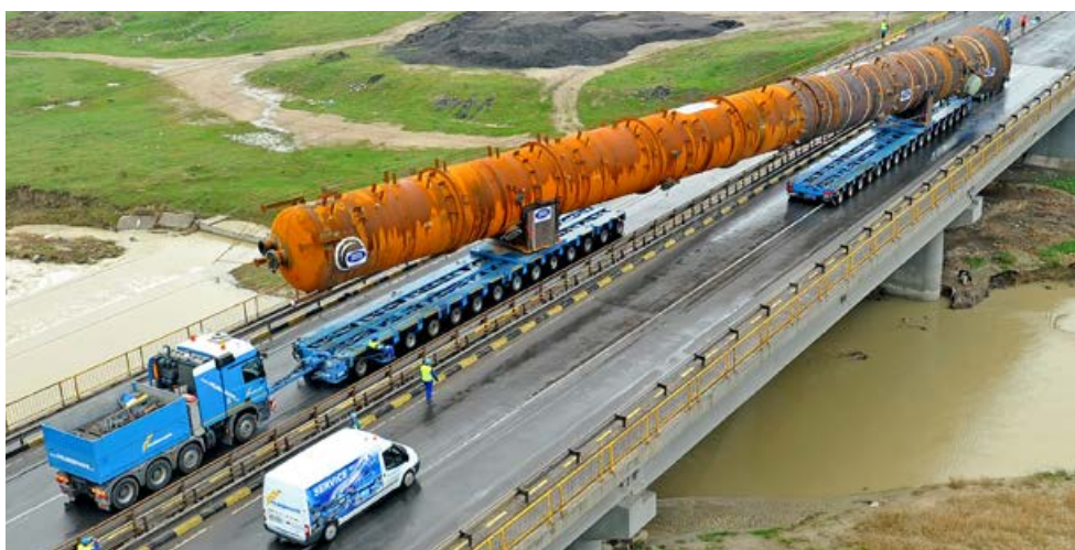
Der Einsatz von Drehschemeln erlaubte das versetzte Überfahren der Brücke.
