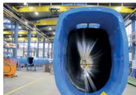
Datorită „tehnologiei poligonale”, pot fi produse brațele cu pereți mai subțiri, cu aceeași stabilitate.
