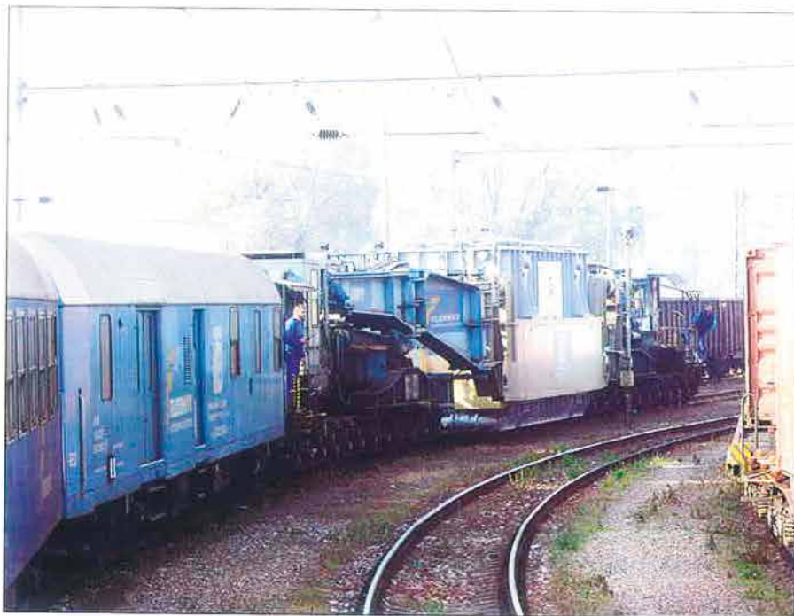
Preprava prvého transformátora, jeho hmotnosť je 236 ton. Na snímke je súprava počas presunu v Bratislave Pálenisku.
