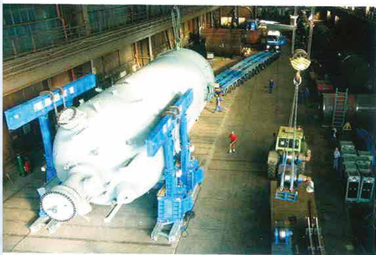
Der 477 t schwere Reaktor wurde in Halle 10 auf dem Felbermayr-Gelände in Linz gefertigt. Mit einem 500 t tragenden Hubgerüst erfolgte die Verladung auf einen Tieflader
