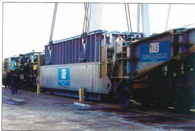
Na prepravu bola použitá súprava ITB s hlbinným vagónom Krupp tsw 348 s pozdĺžnymi nosníkmi, sprievodným a dielenským vagónom.
