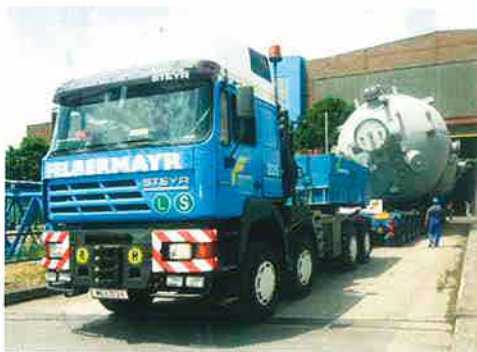
Ausfahrt aus der Halle. Alle 8 Räder der 600 PS Zugmaschine sind angetrieben
