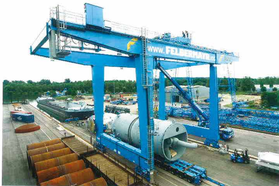
Per Schwerlastkran erreichte der Rekordreaktor das Binnenschiff
