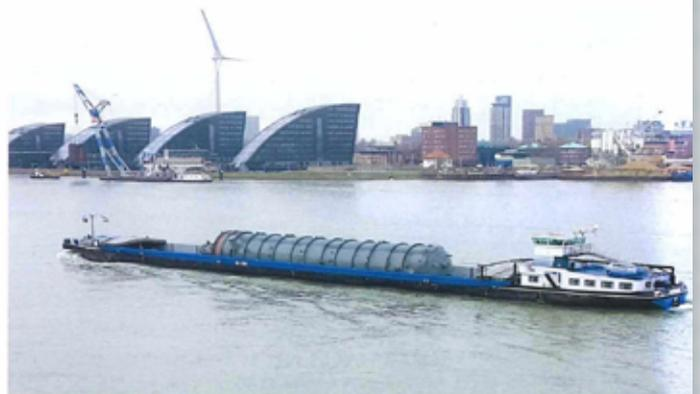
MS BORNRIF mit einem 49 m langen, 7,90 m breiten und 7,75 m hohen, 300 t schweren Reaktor auf dem Weg zum Seehafen Rotterdam | Bild: H&S BORNRIF
