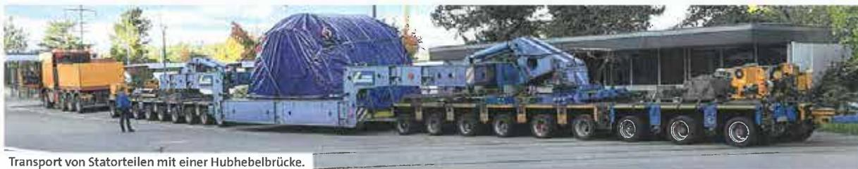
Transport von Statorteilen mit einer Hubhebelbrücke.
