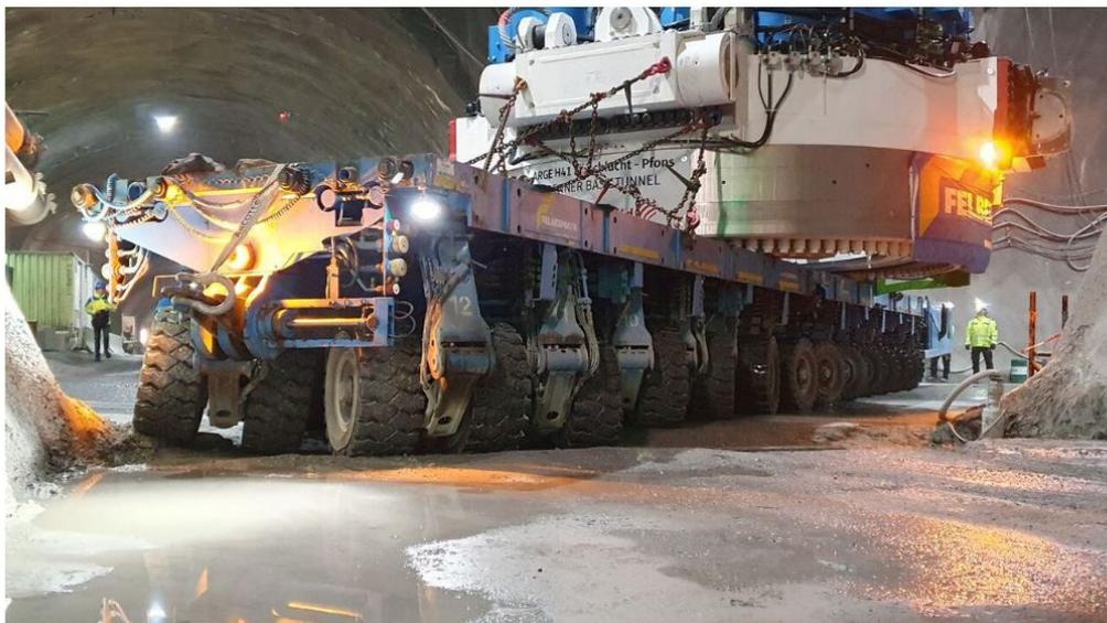
Es war mit großem logistischen Aufwand verbunden, die bis zu 270 Tonnen schweren Komponenten im engen Tunnel zu den Montagekavernen zu fahren. - © Felbermayr/Müller
