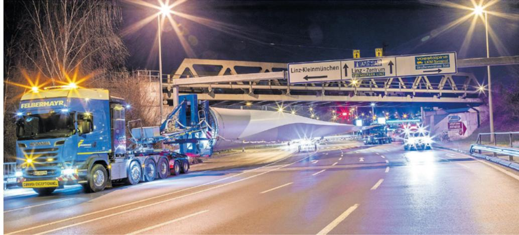
Beim Transport von Rotorblättern sorgen Drehschemel auf der Zugmaschine und auf dem Nachläufer für die nötige Flexibilität in den Kurven. [Felbermayr]
