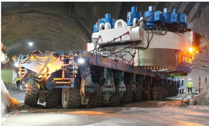
Unter dem Brenner entsteht die mit 55 Kilometern längste unterirdische Eisenbahnverbindung der Welt. Felbermayr hat beginnend mit Anfang des Jahres zwei neue Tunnelbohrmaschinen dorthin transportiert. Viel aufwendiger war es aber, die bis zu 270 Tonnen schweren Komponenten in teils sehr abschüssigen und engen Tunnels zu den Montagekavernen zu fahren und dort zu montieren.
