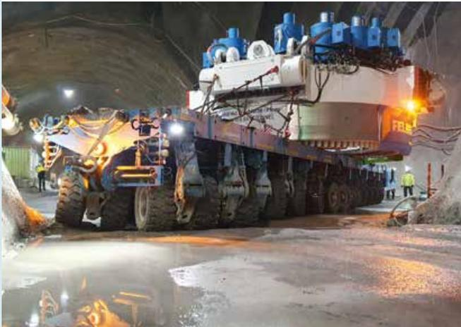
Es war mit großem logistischen Aufwand verbunden, die bis zu 270 Tonnen schweren Komponenten im engen Tunnel zu den Montagekavernen zu fahren.
