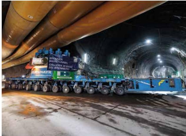
Für die Transporte wurden die Selbstfahrer SPMT von Scheuerle mit sechs, zehn oder zwölf Achsen eingesetzt.
