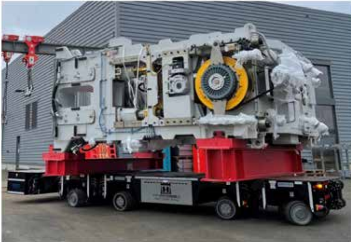
Innerbetrieblicher Transport einer 110-Tonnen-Monoblockpresse mit Hilfe eines selbstfahrenden Industrierollers
