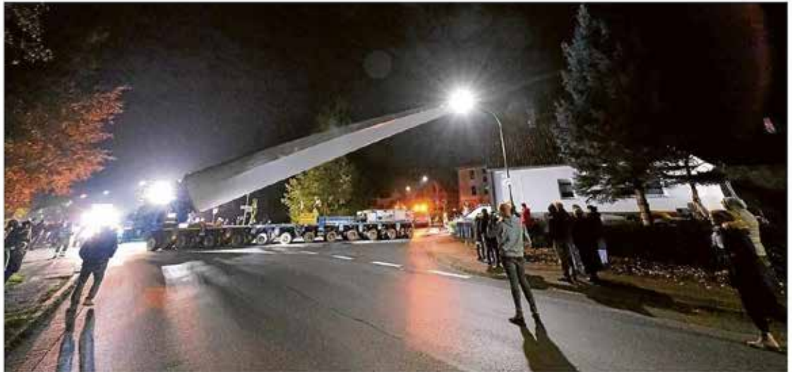
Turmtelle und Windblattflügel für ein Windrad werden derzeit im Kalletal vom Umladeplatz zur Baustelle mit einem Spezialfahrzeug transportiert.
