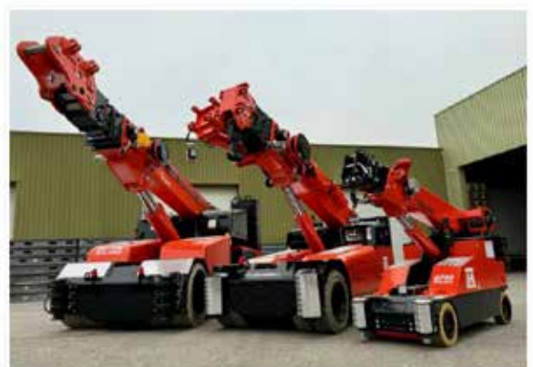
Moderne, elektrisch betriebene und ferngesteuerte Pick- und Carry-Krane mit einer Tragfähigkeit von bis zu 72 Tonnen
