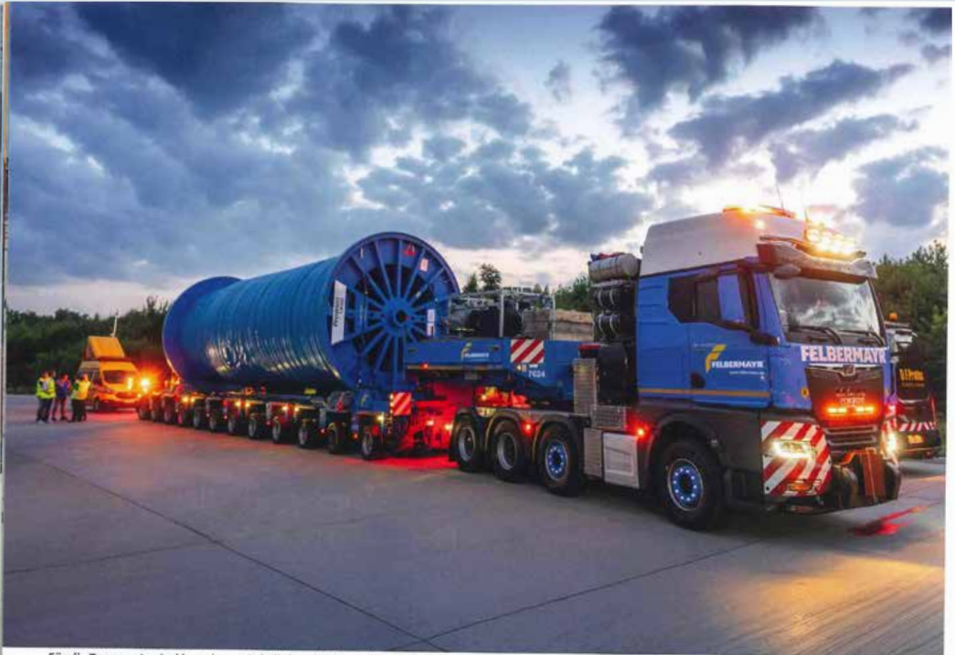
Für die Transporte sind brandneue Achslinien des Herstellers Goldhofer sowie die leistungsstarken 4-Achs-Zugmaschinen der Marke MAN TGX 41.640 im Einsatz.
