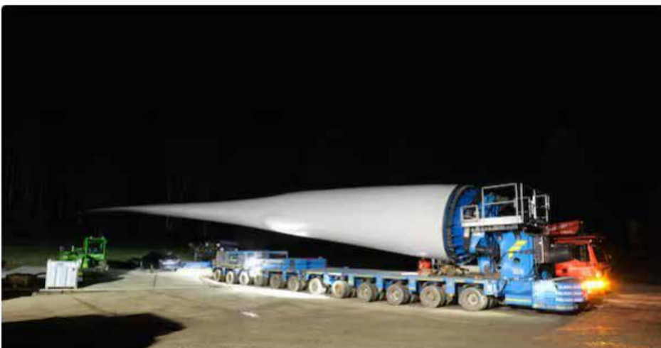
Turmteile und Windblattflügel für ein Windrad werden derzeit im Kalletal vom Umladeplatz zur Baustelle mit einem Spezialfahrzeug transportiert.
