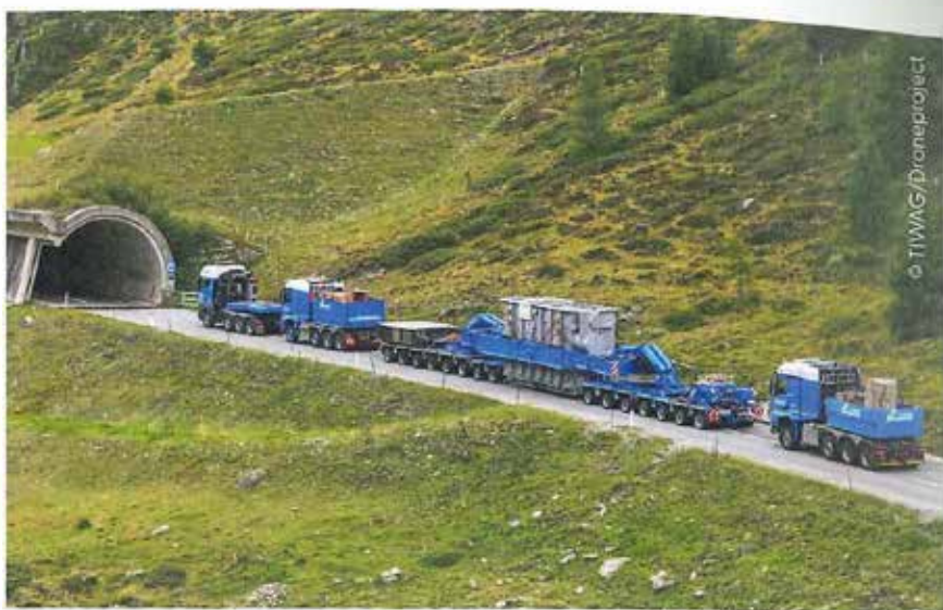
Transport des ersten Maschinentrafos für das neue PSKW Kühtai 2
