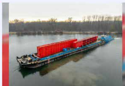
Das Schubschiff „Grafenau“ transportierte die Hafenterteile auf einem Leichter.
