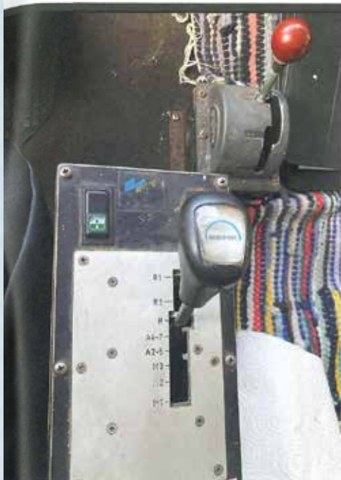
SIEBEN GÄNGE Kulissee des Renk-Lastschaltgetriebes und die plombierte Notbetätigung.
