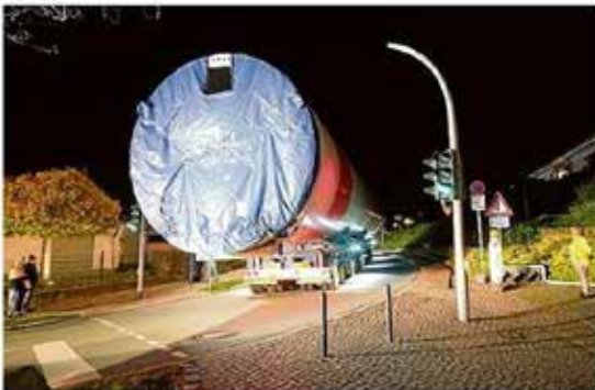
Entlang der Route wurden Hindernisse beseitigt, etwa dieser Ampelmast demontiert, damit Turmtelle und Windblattflügel passieren können.
