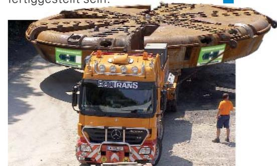
Das Herzstück der Tunnelbohrmaschine: ein Schneidrad mit zwölf Metern Durchmesser und 200 Tonnen Gewicht.
