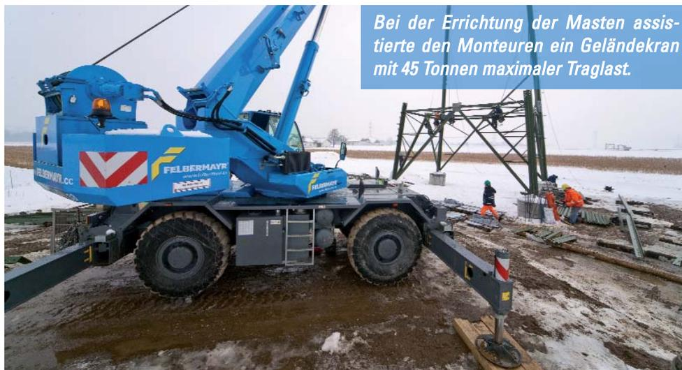
**Bei der Errichtung der Masten assistierte den Monteuren ein Geländekran mit 45 Tonnen maximaler Traglast.**
