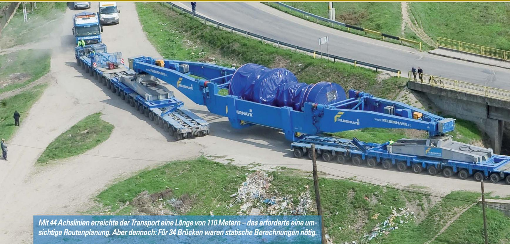
Mit 44 Achslinien erreichte der Transport eine Länge von 110 Metern – das erforderte eine umsichtige Routenplanung. Aber dennoch: Für 34 Brücken waren statische Berechnungen nötig.
