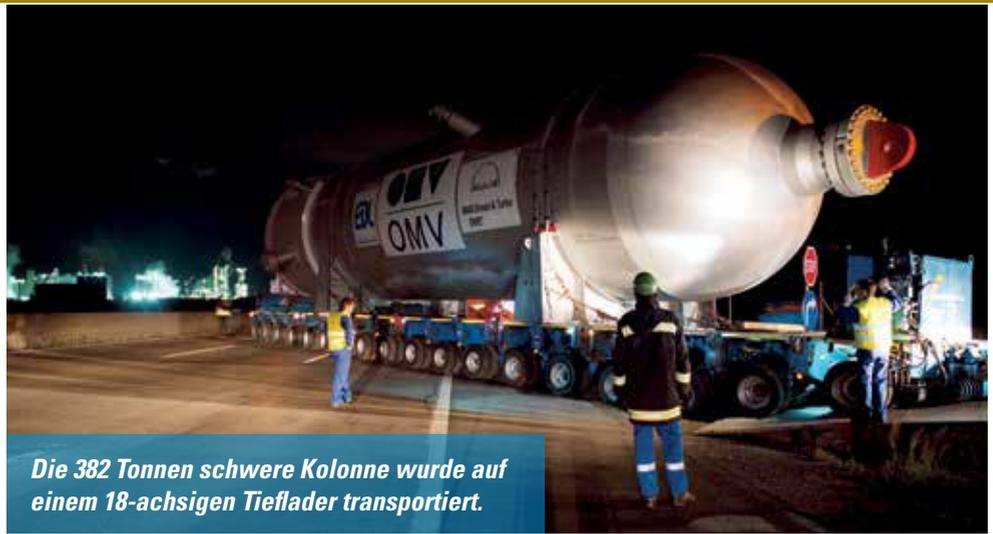
**Die 382 Tonnen schwere Kolonne wurde auf einem 18-achsigen Tieflader transportiert.**
