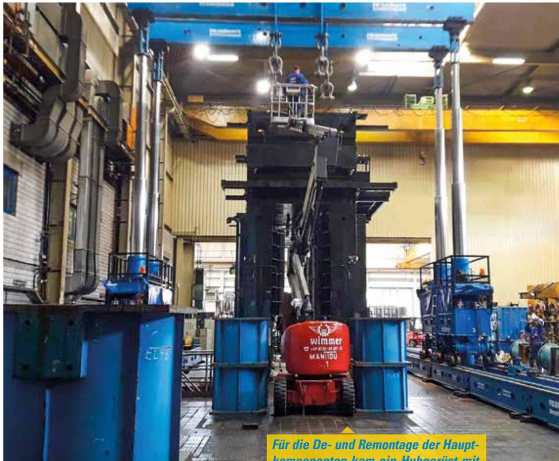
**Für die De- und Remontage der Hauptkomponenten kam ein Hubgerüst mit 1.000 Tonnen Hubkraft zum Einsatz.**
