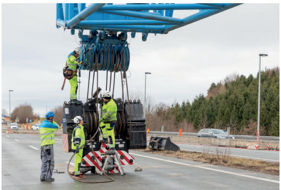
**Jedes der beiden Hubseile des LR 11000 ist 1.450 Meter lang und wiegt etwa 7,4 Tonnen.**
