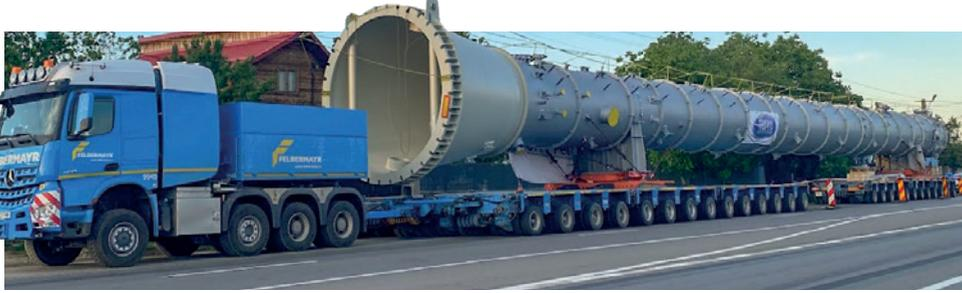
Im Mai wurden insgesamt fünf Kolonnen vom Werk BETA SA Buzău in die OMV Petrom Raffinerie in Brazi de Sus, 70 Kilometer nördlich von Bukarest, transportiert. Das Transportgesamtwicht des größten, 88 Meter langen, Transports belief sich auf massive 463 Tonnen. Das Eigengewicht
