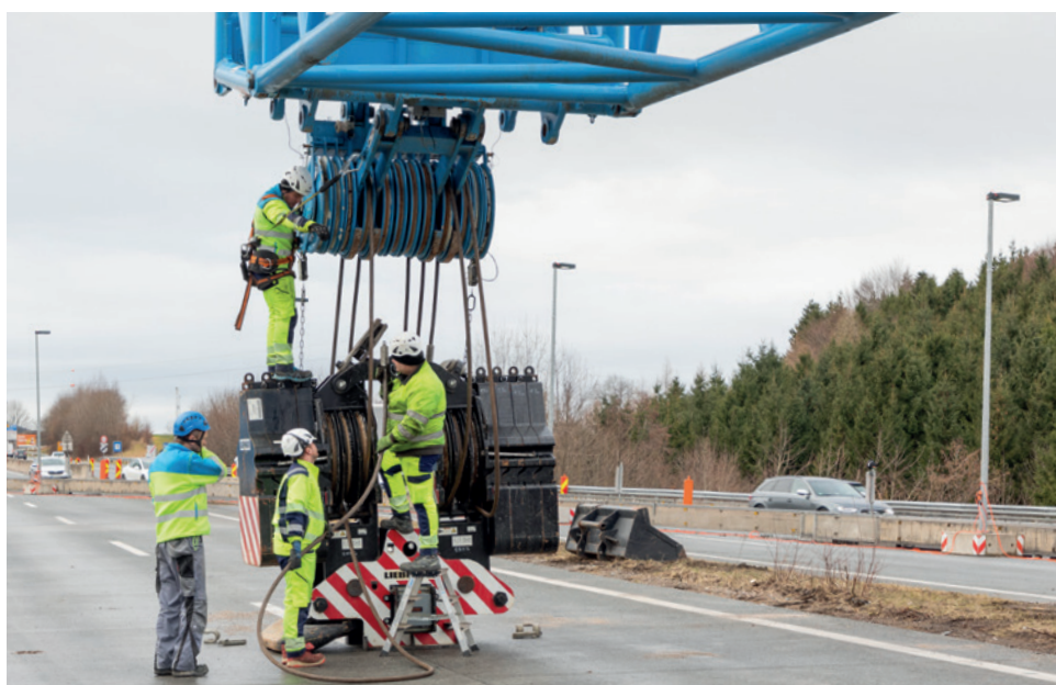
Fiecare dintre cele două frânghii de ridicare ale modelului LR 11.000 are o lungime de 1.450 m și cântărește aproximativ 7,4 tone
